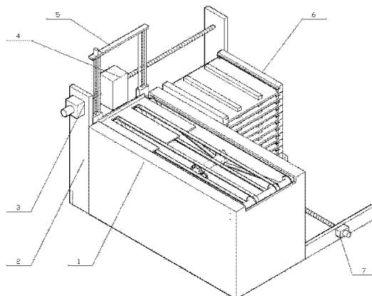
1. 大面积铝基板收集机,其特征在于:包括一接驳台(1),接驳台(1)安装于铝基板隧道炉的出口处,接驳台(1)上安装皮带带轮传动机构,皮带上放置大面铝基板;
