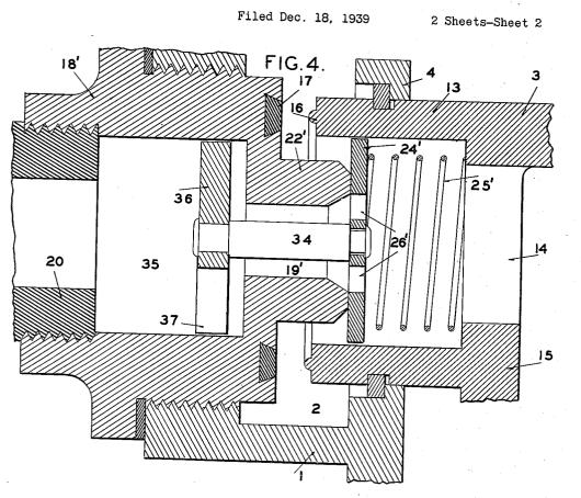
S. SCHNELL VALUE MECHANISM FOR MASTER CYLINDERS
