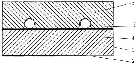
1、一种冰箱温度平衡装置，其特征在于，所述冰箱温度平衡装置包括蓄冷盒，所述蓄冷盒设置在冰箱冷藏室箱体的外侧顶面上，并且与所述箱体形成导热接触，所述蓄冷盒与经过所述箱体上方的冰箱的蒸发器管路形成导热接触，所述蓄冷盒中装有蓄冷液。
