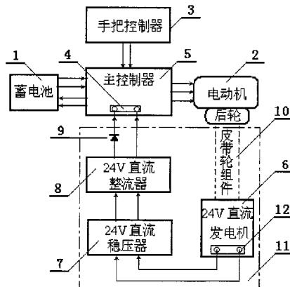
1. 一种电动车蓄电池充电装置，主体包含有蓄电池（1）、设置在电动车后轮主轴上的电动机（2）、手把控制器（3）和上带蓄电池充电接口（4）的主控制器（5），其特征在于所述的主控制器（5）的充电接口（4）与后轮主轴之间设置有包括 24V 直流发电机（6）、24V 直流稳压器（7）、24V 直流整流器（8）、单向二极管（9）及皮带轮组件（10）的充电组件（11），其中：所述的皮带轮组件（11）设置在后轮主轴和 24V 直流发电机（6）的转轴之间；所述的 24V 直流稳压器（7）、24V 直流整流器（8）和单导二极管（9）依次串接设置在 24V 直流发电机（6）的供电输出端（12）和主控制器（5）上的蓄电池充电接口（4）之间。
