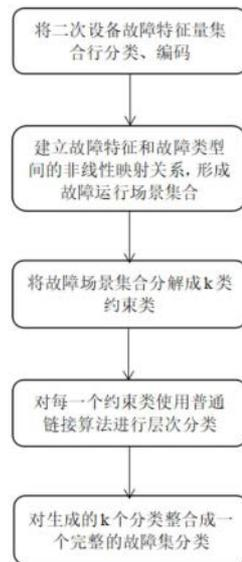
1. 一种基于极限学习机的智能变电站二次设备状态评估方法,其特征在于:包括:二次设备故障特征信息聚类 and 二次设备故障状态评估两部分;
