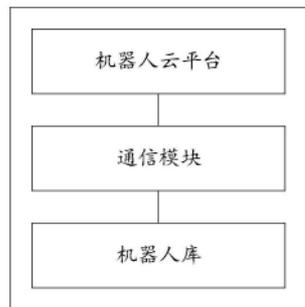
1. 一种园区智能机器人系统,其特征在于,包括机器人云平台、机器人库和通信模块;所述机器人云平台通过所述通信模块与所述机器人库中的若干个机器人通信连接;
