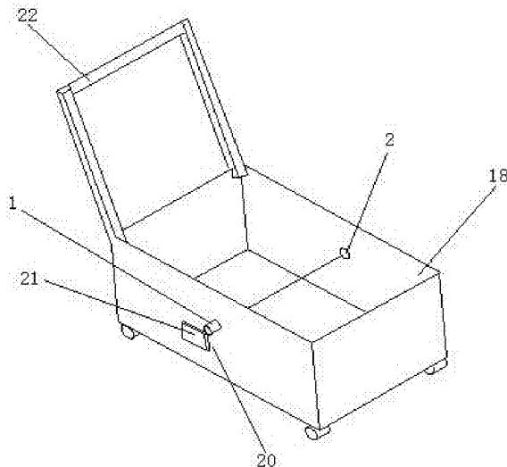
1. 一种电子物料车，其特征在于其包括结构部分和电路部分，所述结构部分包括布车车身(18)、红外检测接受端(1)、红外检测发射端(2)、微控制器模块(21)、射频标签(20)，红外检测接受端(1)和红外检测发射端(2)分别设置在布车车身(18)两侧，微控制器模块(21)、射频标签(20)分别设置在布车车身(18)上红外检测接受端(1)的同侧；所述电路部分包括处理器(3)、处理器接口(4)、射频读写模块(19)、Balun模块(13)、信号放大器(16)、低通滤波器(15)、定向耦合器(14)、天线(17)，其中射频读写模块(19)包括：数字转换模块(6)、增益滤波模块(7)、DRM滤波模块(8)、变频混合器(10)、射频信号接收接口(12)、EPC Gen2协议控制器(5)、射频发送模块(9)、射频发送接口(11)和LED指示灯(22)。
