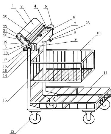
1. 消毒手推车，包括有车架（13）、上货篮（10）、下货篮（11）、车轮（12），其特征在于：所述的消毒手推车由消毒装置与普通手推车构成。
