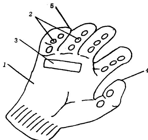
1、一种掐指式手套手机，其特征在于：在手套的每个手指上均布设置有多个手机按键，手机手掌上设置有柔性显示屏，手背有电路板和手机充电接口，在大拇指端部设置有内隐式听筒，小拇指端部设置有内隐式话筒。
