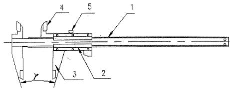
1. 一种测量密封垫环的游标卡尺，包括卡尺体（1）、游标（2）、外径量爪（3）、内径量爪（4）、锁紧螺钉（5）、密封垫环型号（6），其特征在于：游标（2）与卡尺体（1）活动连接，在卡尺体（1）上分别安装有外径量爪（3）、内径量爪（4），游标（2）上设有锁紧螺钉（5），卡尺体（1）上设有密封垫环型号（6）。
