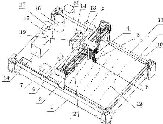
1. 一种生物芯片点样仪,包括支架,所述的支架上设置有带有伺服电机的 X 向运行机构、Y 向运行机构和 Z 向运行机构,其特征是 :所述的 Z 向运行机构上设置有带有针头的针头固定座,所述的支架上设置有点样平台,在点样平台一侧的支架上设置有样品盒固定座、超声清洗干燥盒和电子频闪拍照装置。
