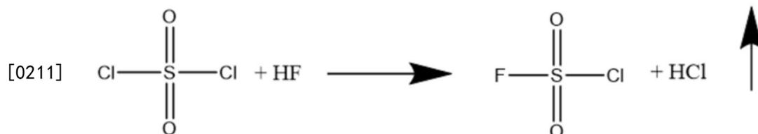
[0212] 在99.9%的HCl已经离开高压釜(通过分析洗涤器中的氯化物计算)之后,将剩余含量(其几乎为100%SO<sub>2</sub>ClF+HF)转移到不锈钢塔中并且在5巴下从HF中蒸馏出SO<sub>2</sub>ClF,产率:94%(91g)。高挥发性SO<sub>2</sub>ClF(bp(沸点):7°C)再次放入高压釜中,冷却至-30°C,作为下一步骤的准备。
