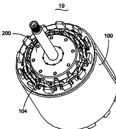
1. 一种永磁电机，包括定子和设置于定子内的转子，其特征在于，该定子包括具有 12 个定子齿的定子铁芯和绕设于该定子齿上的线圈，该转子包括转轴及固定至该转轴的至少一个磁芯组，该磁芯组包括沿转子周向间隔设置的 8 个转子铁芯及 8 个由铁氧体材料制成的永磁铁，各永磁铁夹设于相邻两转子铁芯之间，各永磁铁沿转子周向极化并且相邻永磁铁的极性相反。
