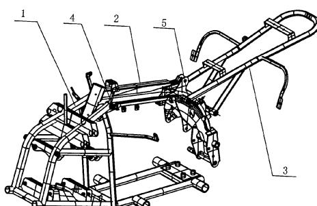
1、一种三段式沙滩车主车架，其特征是由前主车架，中间弯管车架，后主车架组成，螺栓紧固连接前主车架和中间弯管车架，螺栓紧固连接中间弯管车架和后主车架。
