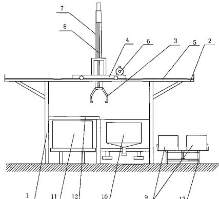
1. 一种全自动涂覆机器人，其特征在于：包括多根立柱（1）、水平支架（2）、升降装置、行走装置（6）、机械手（3）、控制箱、滑块（4），所述水平支架（2）安装在立柱（1）的顶端，在支架（2）上设有导轨（5），所述滑块（4）通过行走装置（6）在导轨（5）上来回移动；所述升降装置包括气缸（7），气缸（7）固定在滑块（4）上，气缸（7）中的活塞杆（8）穿过滑块（4）后与机械手（3）连接；在支架（2）的下方从左至右依次设有浸渍篮（9）、浸渍装置（10）、离心装置（11）；在支架（2）上并在与浸渍篮（9）、浸渍装置（10）、离心装置（11）相对应的位置上分别安装有光电开关；气缸（7）、行走装置（6）以及每个光电开关分别与控制箱连接。
