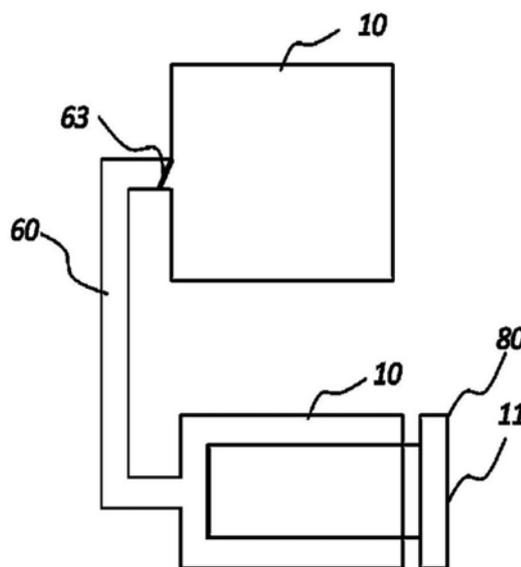
1. 一种冰箱,包括第一间室及第二间室,所述第二间室内容纳抽屉,所述抽屉的前表面设置门体,其特征在于,还包括一管道,所述管道一端与第一间室连接,另一端与第二间室连接,所述管道设置风门开关,所述门体设置传感器,所述传感器与风门开关电性连接,所述传感器受触发能够开启风门开关,以使第一间室与第二间室气压平衡。
