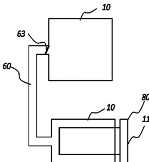
1. 一种冰箱，包括第一间室及第二间室，所述第二间室内容纳抽屉，所述抽屉的前表面设置门体，其特征在于，还包括一管道，所述管道第一端与第一间室连接，第二端与第二间室连接，所述管道设置风门开关，所述门体设置传感器，所述传感器与风门开关电性连接，所述传感器受触发能够开启风门开关，以使第一间室与第二间室气压平衡。
