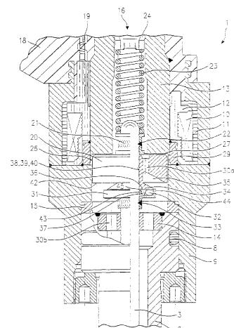
1. 燃料喷射阀 (1)，特别是用于内燃机燃料喷射装置的燃料喷射阀，具有一个阀针 (3)，其阀关闭体 (4) 与一个阀座面 (6) 配合作用构成一个密封座，具有一个作用在阀针 (3) 上的衔铁 (20)，在这里，衔铁 (20) 可轴向移动地安置在阀针 (3) 上并且被一个由弹性体制成的、安装在一个法兰 (31) 和衔铁 (20) 之间的减振元件 (32) 阻尼，
