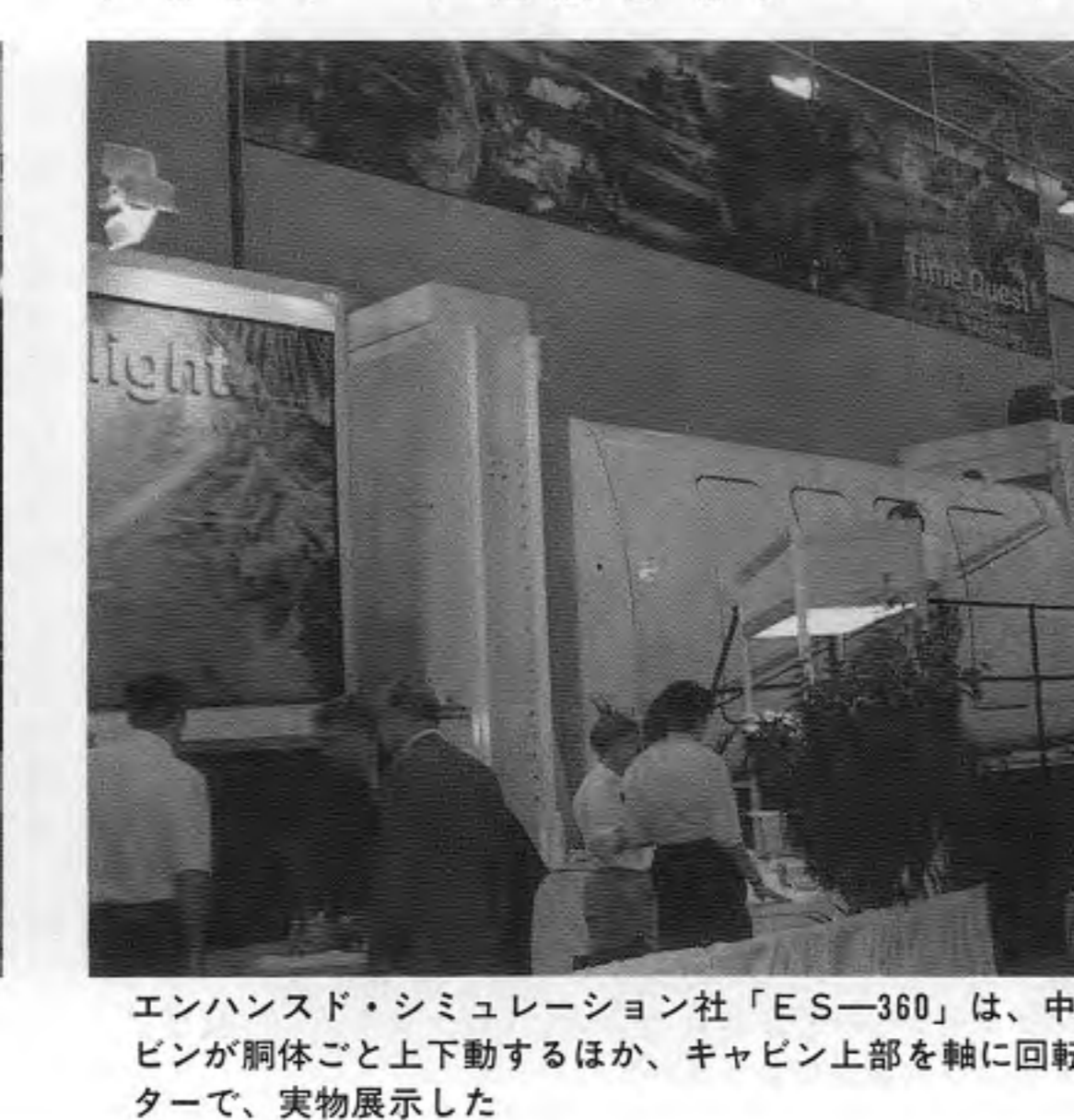
エンハンスド・シミュレーション社「ES-360」は、中央部分の大きなキャビンが胴体ごと上下動するほか、キャビン上部を軸に回転する映像シミュレーターで、実物展示した
