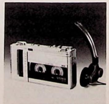
3 Batterien (UM-3) oder ein 220-V-Adapter. Für den aufklappbaren Kopfhörer stehen 2 x 33 mW Ausgangsleistung bereit. Der Geräuschspannungs-Abstand soll größer als 50 dB sein und der Übertragungsbereich mit Metallband von 40 Hz bis 16 kHz reichen (LH: 40 Hz bis 12,5 kHz). Der Wert der Gleichlaufschwankungen wird mit 0,2% WRMS angegeben (Bandgeschwindigkeit 4,8 cm/s). Preis: etwa 500 DM.
