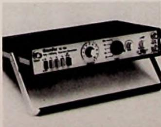
Bereich von 0,01 Hz bis 100 kHz gewobbeln. Bis zu einem Verhältnis von 300:1 ist der Bereich innerhalb einer Toleranz von ± 5% linear. Bei eingeschränkter Genauigkeit kann ein Wobbelhub von 1000:1 erreicht werden. Dem 600-Ω-Ausgang ist ein Abschwächer mit den Positionen 0 dB und -40 dB sowie ein Feineinsteller nachgeschaltet. Der DC-Offset ist um ± 5 V variierbar (Preis: 445 DM).
