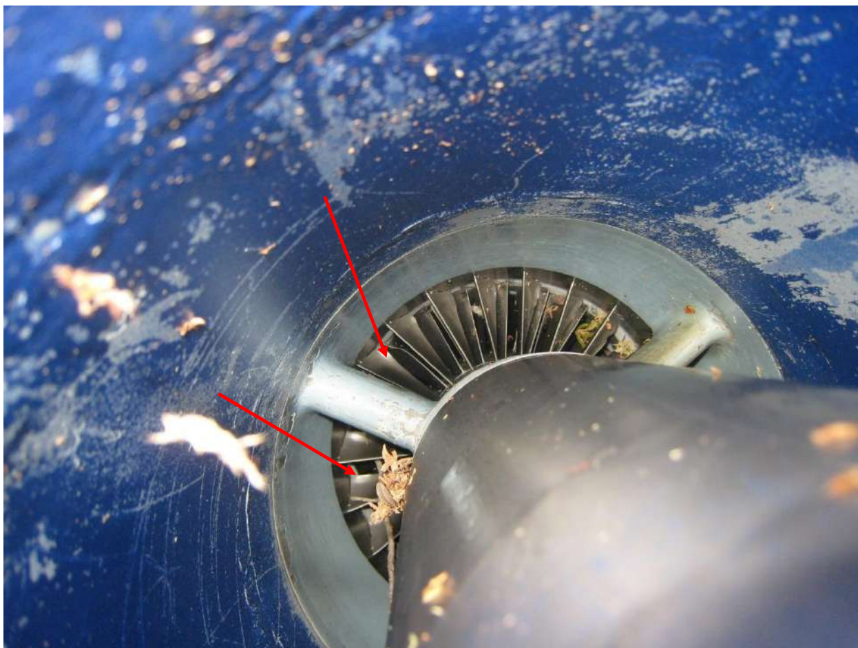
Рис. 4. Повреждения лопаток ВНА левого двигателя (указаны стрелками)
