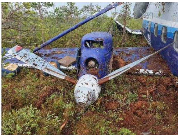
Рис. 16. Внешний вид силовых установок после АП: а) левая; б) правая
