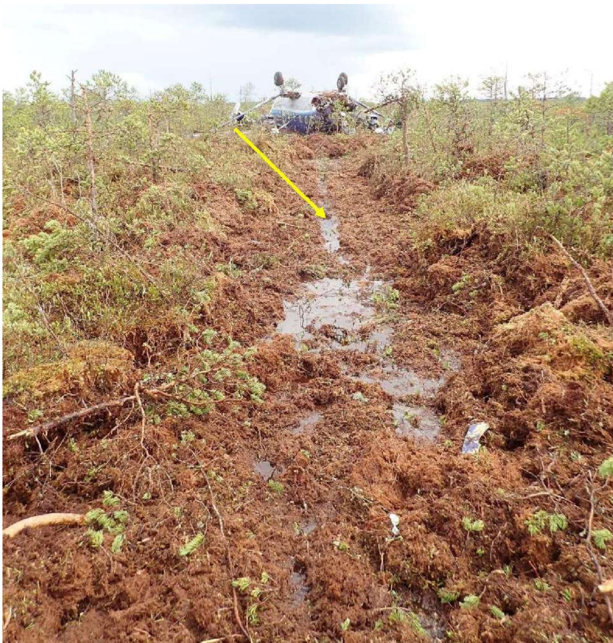
Рис. 14. След нижней части фюзеляжа и передней стойки ВС (указан стрелкой)
