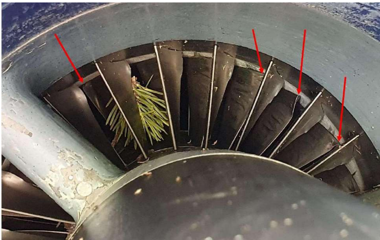
Рис. 5. Повреждения лопаток первой ступени компрессора левого двигателя (указаны стрелками)
