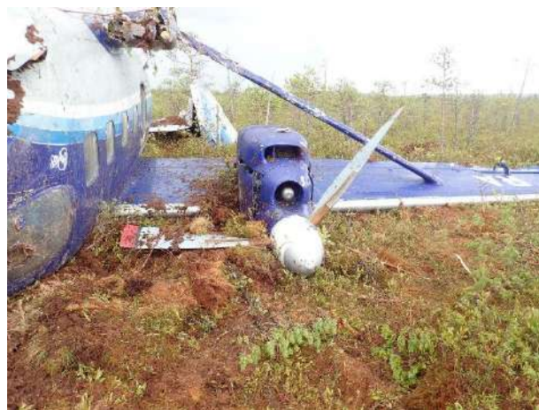
Рис. 16. Внешний вид силовых установок после АП: а) левая; б) правая
