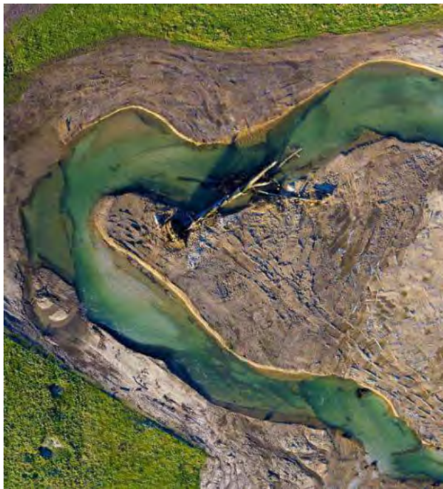
Abbildung 7: Strukturvielfalt einen Monat nach Fertigstellung (Januar 2012); Kies, Sand und Lehm sowie die große Tiefenvarianz sind im Gerinne zu erkennen (Quelle: WOL).
