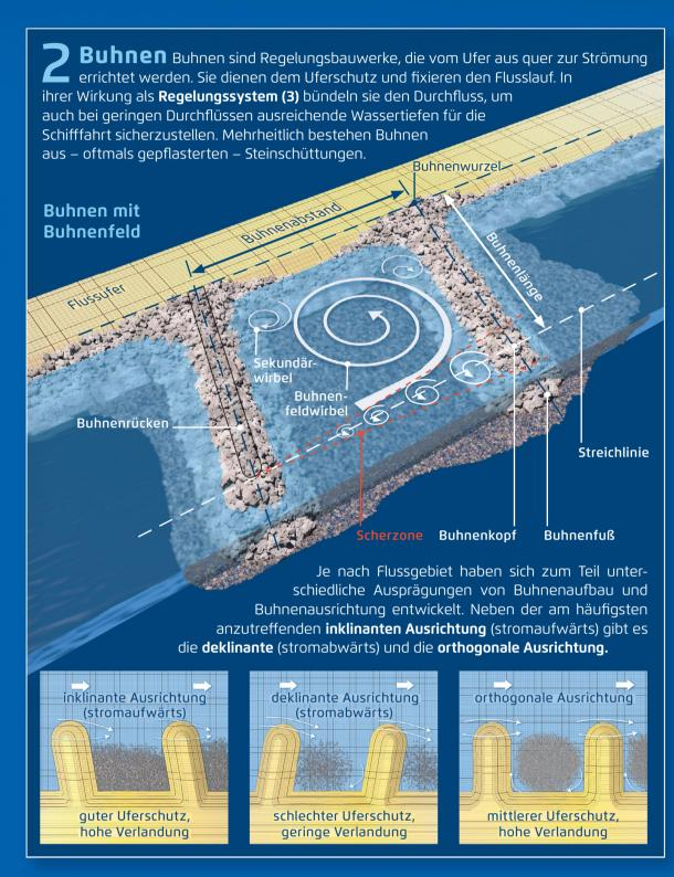
Hydraulik Die hydraulische Wirkung von Buhnen hängt entscheidend davon ab, ob sie umströmt oder, wie im Fall höherer Wasserstände, überströmt werden.
