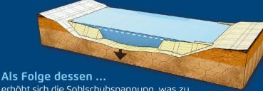
erhöht sich die Sohlschubspannung, was zu einer begrenzten Sohleintiefung führt.
