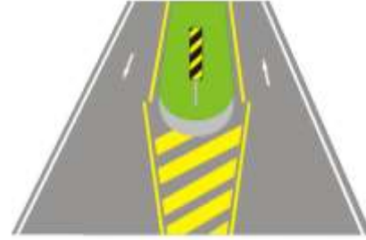
Figura 4.5b Vías de doble sentido de circulación
