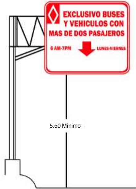
Figura 2.8 Señal reglamentaria elevada Tipo "bandera" con superelevación
