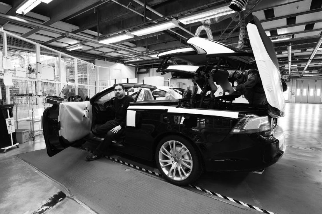
Vid slutmonteringen. Bilbyggare provar att funktion och montering av cabriolet och bagage är riktig, 2013. Foto: Cecilia Ahlsén, Bohusläns museum
