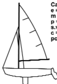
420 e = 4.20 m m = 1.63 m p = 100 kg s.v. = 10.26 m 2 (spinnaker) c = poliester
