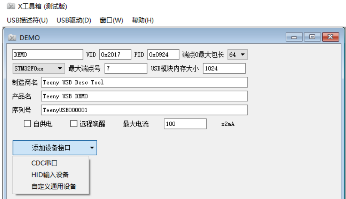
图22 TeenyDT 图形界面 在这里编辑设备 VID、PID、厂商名称等信息。
