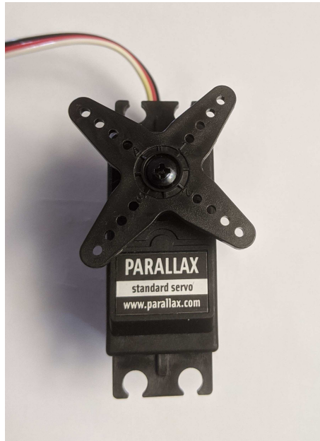
Figura 10.6: Fotografia del servomotor Parallax usat
