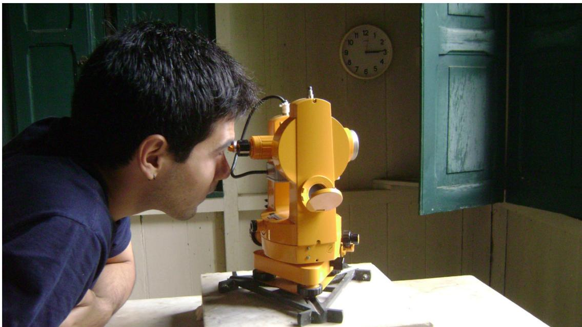
**Figura 2.1:** Realizando medidas da direção do campo geomagnético no observatório de Vassouras, Rio de Janeiro. A atividade foi parte de uma disciplina de instrumentação geofísica que cursei durante a pós-graduação do Observatório Nacional.
