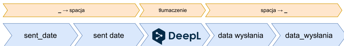
Rys. 4.7: Schemat algorytmu do tłumaczenia oryginalnych nazw tabel i kolumn
