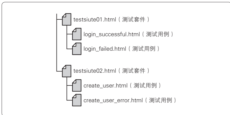
图 7.7 使用测试套件的结构示例
