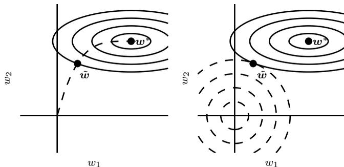
图 7.4: 提前终止效果的示意图。(左) 实线轮廓线表示负对数似然的轮廓。虚线表示从原点开始的 SGD 所经过的轨迹。提前终止的轨迹在较早的点  $\tilde{w}$  处停止, 而不是停止在最小化代价的点  $w^*$  处。(右) 为了对比, 使用  $L^2$  正则化效果的示意图。虚线圆圈表示  $L^2$  惩罚的轮廓,  $L^2$  惩罚使得总代价的最小值比非正则化代价的最小值更靠近原点。
