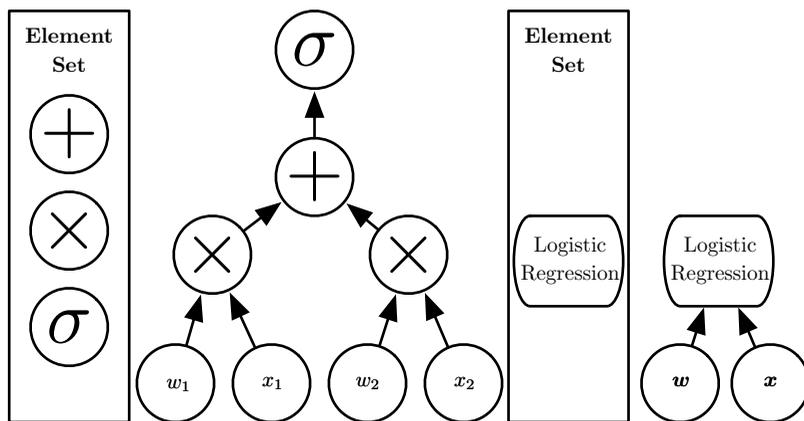
图 1.3: 将输入映射到输出的计算图表的示意图，其中每个节点执行一个操作。深度是从输入到输出的最长路径的长度，但这取决于可能的计算步骤的定义。这些图中所示的计算是逻辑回归模型的输出， $\sigma(\mathbf{w}^T \mathbf{x})$ ，其中  $\sigma$  是 logistic sigmoid 函数。如果我们使用加法、乘法和 logistic sigmoid 作为我们计算机语言的元素，那么这个模型深度为三。如果我们将逻辑回归视为元素本身，那么这个模型深度为一。
