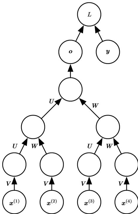
图 10.14: 递归网络将循环网络的链状计算图推广到树状计算图。可变大小的序列  $\mathbf{x}^{(1)}, \mathbf{x}^{(2)}, \dots, \mathbf{x}^{(t)}$  可以通过固定的参数集合（权重矩阵  $\mathbf{U}, \mathbf{V}, \mathbf{W}$ ）映射到固定大小的表示（输出  $\mathbf{o}$ ）。该图展示了监督学习的情况，其中提供了一些与整个序列相关的目标  $\mathbf{y}$ 。
