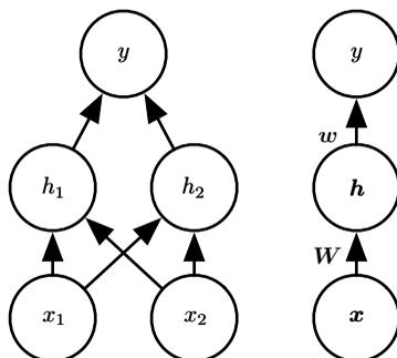
图 6.2: 使用两种不同样式绘制的前馈网络的示例。具体来说, 这是我們用来解决 XOR 问题的前馈网络。它有单个隐藏层, 包含两个单元。(左) 在这种样式中, 我们将每个单元绘制为图中的一个节点。这种风格是清楚而明确的, 但对于比这个例子更大的网络, 它可能会消耗太多的空间。(右) 在这种样式中, 我们将表示每一层激活的整个向量绘制为图中的一个节点。这种样式更加紧凑。有时, 我们对图中的边使用参数名进行注释, 这些参数是用来描述两层之间的关系。这里, 我们用矩阵  $\mathbf{W}$  描述从  $\mathbf{x}$  到  $\mathbf{h}$  的映射, 用向量  $\mathbf{w}$  描述从  $\mathbf{h}$  到  $y$  的映射。当标记这种图时, 我们通常省略与每个层相关联的截距参数。
