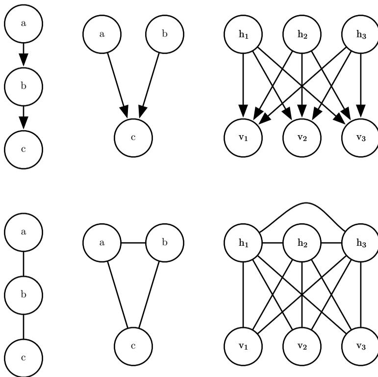
图 16.11: 通过构造道德图将有向模型（上一行）转化为无向模型（下一行）的例子。（左）只需要把有向边替换成无向边就可以把这个简单的链转化为一个道德图。得到的无向模型包含了完全相同的独立关系和条件独立关系。（中）这个图是在不丢失独立性的情况下是无法转化为无向模型的最简单的有向模型。这个图包含了单个完整的不道德结构。因为  $a$  和  $b$  都是  $c$  的父节点，当  $c$  被观察到时，它们之间通过活跃路径相连。为了捕捉这个依赖，无向模型必须包含一个含有所有三个变量的团。这个团无法编码  $a \perp b$  这个信息。（右）一般来说，道德化的过程会给图添加许多边，因此丢失了一些隐含的独立性。举个例子，这个稀疏编码图需要在每一对隐藏单元之间添加道德化的边，因此也引入了二次数量级的新的直接依赖。
