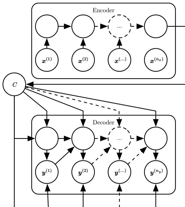
图 10.12: 在给定输入序列  $(\mathbf{x}^{(1)}, \mathbf{x}^{(2)}, \dots, \mathbf{x}^{(n_x)})$  的情况下学习生成输出序列  $(\mathbf{y}^{(1)}, \mathbf{y}^{(2)}, \dots, \mathbf{y}^{(n_y)})$  的编码器-解码器或序列到序列的 RNN 架构的示例。它由读取输入序列的编码器 RNN 以及生成输出序列（或计算给定输出序列的概率）的解码器 RNN 组成。编码器 RNN 的最终隐藏状态用于计算一般为固定大小的上下文变量  $C$ ， $C$  表示输入序列的语义概要并且作为解码器 RNN 的输入。
