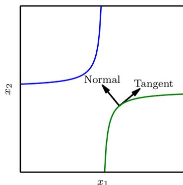
图 7.9: 正切传播算法 (Simard *et al.*, 1992) 和流形正切分类器主要思想的示意图 (Rifai *et al.*, 2011c), 它们都正则化分类器的输出函数  $f(\mathbf{x})$ 。每条曲线表示不同类别的流形, 这里表示嵌入二维空间中的一维流形。在一条曲线上, 我们选择单个点并绘制一个与类别流形 (平行并接触流形) 相切的向量以及与类别流形 (与流形正交) 垂直的向量。在多维情况下, 可以存在许多切线方向和法线方向。我们希望分类函数在垂直于流形方向上快速改变, 并且在类别流形的方向上保持不变。正切传播和流形正切分类器都会正则化  $f(\mathbf{x})$ , 使其不随  $\mathbf{x}$  沿流形的移动而剧烈变化。正切传播需要用户手动指定正切方向的计算函数 (例如指定小平移后的图像保留在相同类别的流形中), 而流形正切分类器通过训练自编码器拟合训练数据来估计流形的正切方向。我们将在第十四章中讨论使用自编码器来估计流形。
