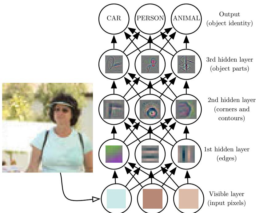
图 1.2: 深度学习模型的示意图。计算机难以理解原始感官输入数据的含义，如表示为像素值集合的图像。将一组像素映射到对象标识的函数非常复杂。如果直接处理，学习或评估此映射似乎是不可能的。深度学习将所需的复杂映射分解为一系列嵌套的简单映射（每个由模型的不同层描述）来解决这一难题。输入展示在 **可见层**（visible layer），这样命名的原因是因为它包含我们能观察到的变量。然后是一系列从图像中提取越来越多抽象特征的 **隐藏层**（hidden layer）。因为它们的值不在数据中给出，所以将这些层称为“隐藏”；模型必须确定哪些概念有利于解释观察数据中的关系。这里的图像是每个隐藏单元表示的特征的可视化。给定像素，第一层可以轻易地通过比较相邻像素的亮度来识别边缘。有了第一隐藏层描述的边缘，第二隐藏层可以容易地搜索可识别为角和扩展轮廓的边集合。给定第二隐藏层中关于角和轮廓的图像描述，第三隐藏层可以找到轮廓和角的特定集合来检测特定对象的整个部分。最后，根据图像描述中包含的对象部分，可以识别图像中存在的对象。经 Zeiler and Fergus (2014) 许可转载此图。
