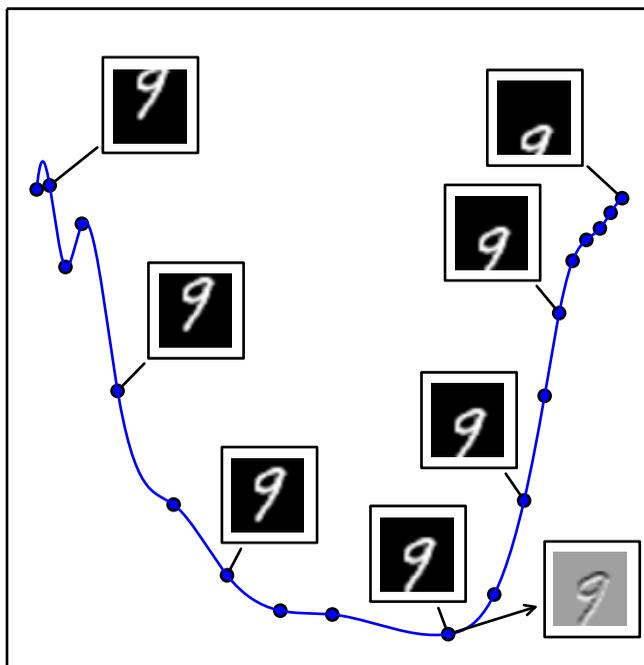
图 14.6: 正切超平面概念的图示。我们在 784 维空间中创建了 1 维流形。我们使用一张 784 像素的 MNIST 图像, 并通过垂直平移来转换它。垂直平移的量定义沿着 1 维流形的坐标, 轨迹为通过图像空间的弯曲路径。该图显示了沿着该流形的几个点。为了可视化, 我们使用 PCA 将流形投影到 2 维空间中。 $n$  维流形在每个点处都具有  $n$  维切平面。该切平面恰好在该点接触流形, 并且在该点处平行于流形表面。它定义为保持在流形上可以移动的方向空间。该 1 维流形具有单个切线。我们在图中示出了一个点处的示例切线, 其中图像表示该切线方向在图像空间中是怎样的。灰色像素表示沿着切线移动时不改变的像素, 白色像素表示变亮的像素, 黑色像素表示变暗的像素。
