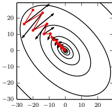
图 8.5: 动量的主要目的是解决两个问题: Hessian 矩阵的病态条件和随机梯度的方差。我们通过此图说明动量如何克服这两个问题的第一个。等高线描绘了一个二次损失函数 (具有病态条件的 Hessian 矩阵)。横跨轮廓的红色路径表示动量学习规则所遵循的路径, 它使该函数最小化。我们在该路径的每个步骤画一个箭头, 表示梯度下降将在该点采取的步骤。我们可以看到, 一个病态条件的二次目标函数看起来像一个长而窄的山谷或具有陡峭边的峡谷。动量正确地纵向穿过峡谷, 而普通的梯度步骤则会浪费时间在峡谷的窄轴上来回移动。比较图 4.6, 它也显示了没有动量的梯度下降的行为。
