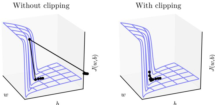
图 10.17: 梯度截断在有两个参数  $w$  和  $b$  的循环网络中的效果示例。梯度截断可以使梯度下降在极陡峭的悬崖附近更合理地执行。这些陡峭的悬崖通常发生在循环网络中，位于循环网络近似线性的附近。悬崖在时间步的数量上呈指数地陡峭，因为对于每个时间步，权重矩阵都自乘一次。(左) 没有梯度截断的梯度下降越过这个小峡谷的底部，然后从悬崖面接收非常大的梯度。大梯度灾难性地将参数推到图的轴外。(右) 使用梯度截断的梯度下降对悬崖的反应更温和。当它上升到悬崖面时，步长受到限制，使得它不会被推出靠近解的陡峭区域。经 Pascanu *et al.* (2013a) 许可可改编此图。
