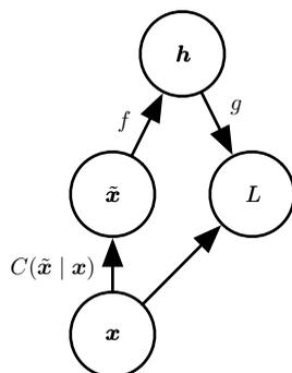
图 14.3: 去噪自编码器代价函数的计算图。去噪自编码器被训练为从损坏的版本  $\tilde{x}$  重构干净数据点  $x$ 。这可以通过最小化损失  $L = -\log p_{\text{decoder}}(x | h = f(\tilde{x}))$  实现,其中  $\tilde{x}$  是样本  $x$  经过损坏过程  $C(\tilde{x} | x)$  后得到的损坏版本。通常,分布  $p_{\text{decoder}}$  是因子的分布(平均参数由前馈网络  $g$  给出)。
