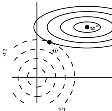
图 7.1:  $L^2$ （或权重衰减）正则化对最佳  $\mathbf{w}$  值的影响。实线椭圆表示没有正则化目标的等值线。虚线圆圈表示  $L^2$  正则化项的等值线。在  $\tilde{\mathbf{w}}$  点，这两个竞争目标达到平衡。目标函数  $J$  的 Hessian 的第一维特征值很小。当从  $\mathbf{w}^*$  水平移动时，目标函数不会增加得太多。因为目标函数对这个方向没有强烈的偏好，所以正则化项对该轴具有强烈的影响。正则化项将  $w_1$  拉向零。而目标函数对沿着第二维远离  $\mathbf{w}^*$  的移动非常敏感。对应的特征值较大，表示高曲率。因此，权重衰减对  $w_2$  的位置影响相对较小。
