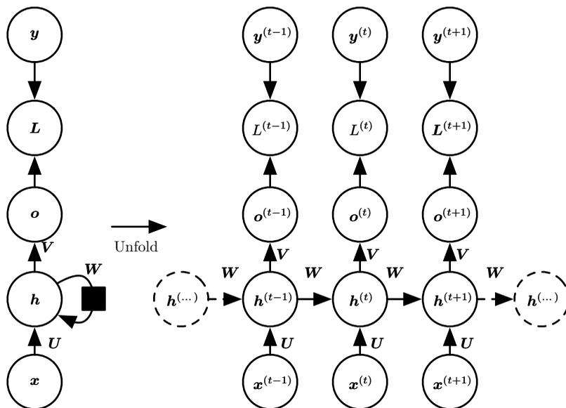
图 10.3: 计算循环网络(将  $x$  值的输入序列映射到输出值  $o$  的对应序列) 训练损失的计算图。损失  $L$  衡量每个  $o$  与相应的训练目标  $y$  的距离。当使用 softmax 输出时，我们假设  $o$  是未归一化的对数概率。损失  $L$  内部计算  $\hat{y} = \text{softmax}(o)$ ，并将其与目标  $y$  比较。RNN 输入到隐藏的连接由权重矩阵  $U$  参数化，隐藏到隐藏的循环连接由权重矩阵  $W$  参数化以及隐藏到输出的连接由权重矩阵  $V$  参数化。式 (10.8) 定义了该模型中的前向传播。(左) 使用循环连接绘制的 RNN 和它的损失。(右) 同一网络被视为展开的计算图，其中每个节点现在与一个特定的时间实例相关联。
