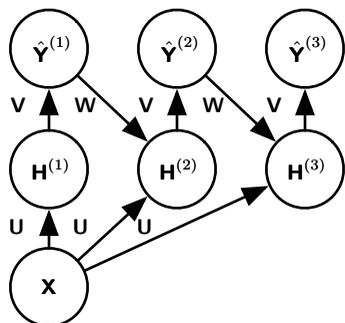
图 9.17: 用于像素标记的循环卷积网络的示例。输入是图像张量  $X$ ，它的轴对应图像的行、列和通道（红，绿，蓝）。目标是输出标签张量  $\hat{Y}$ ，它遵循每个像素的标签的概率分布。该张量的轴对应图像的行、列和不同类别。循环网络通过使用  $\hat{Y}$  的先前估计作为创建新估计的输入，来迭代地改善其估计，而不是单次输出  $\hat{Y}$ 。每个更新的估计使用相同的参数，并且估计可以如我们所愿地被改善任意多次。每一步使用的卷积核张量  $U$ ，是用来计算给定输入图像的隐藏表示的。核张量  $V$  用于产生给定隐藏值时标签的估计。除了第一步之外，核  $W$  都对  $\hat{Y}$  进行卷积来提供隐藏层的输入。在第一步中，此项由零代替。因为每一步使用相同的参数，所以这是一个循环网络的例子，如第十章所述。
