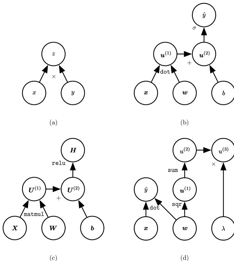
图 6.8: 一些计算图的示例。(a) 使用  $\times$  操作计算  $z = xy$  的图。(b) 用于逻辑回归预测  $\hat{y} = \sigma(\mathbf{x}^\top \mathbf{w} + b)$  的图。一些中间表达式在代数表达式中没有名称，但在图形中却需要。我们简单地将第  $i$  个这样的变量命名为  $u^{(i)}$ 。(c) 表达式  $\mathbf{H} = \max\{0, \mathbf{X}\mathbf{W} + \mathbf{b}\}$  的计算图，在给定包含小批量输入数据的设计矩阵  $\mathbf{X}$  时，它计算整流线性单元激活的设计矩阵  $\mathbf{H}$ 。(d) 示例 a-c 对每个变量最多只实施一个操作，但是对变量实施多个操作也是可能的。这里我们展示一个计算图，它对线性回归模型的权重  $\mathbf{w}$  实施多个操作。这个权重不仅用于预测  $\hat{y}$ ，也用于权重衰减罚项  $\lambda \sum_i w_i^2$ 。
