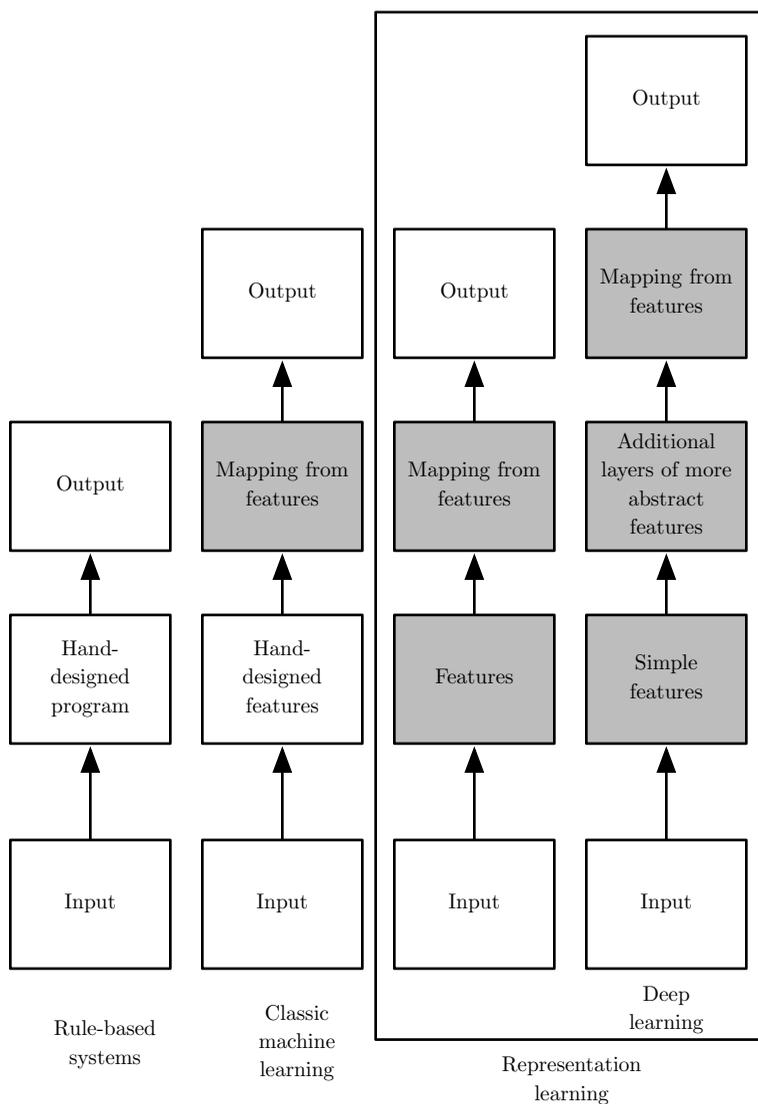
图 1.5: 流程图展示了 AI 系统的不同部分如何在不同的 AI 学科中彼此相关。阴影框表示能从数据中学习的组件。
