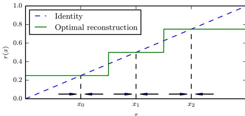
图 14.7: 如果自编码器学习到对数据点附近的小扰动不变的重构函数，它就能捕获数据的流形结构。这里，流形结构是 0 维流形的集合。虚线对角线表示重构的恒等函数目标。最佳重构函数会在存在数据点的任意处穿过恒等函数。图底部的水平箭头表示在输入空间中基于箭头的  $r(\mathbf{x}) - \mathbf{x}$  重建方向向量，总是指向最近的“流形”（1 维情况下的单个数据点）。在数据点周围，去噪自编码器明确地尝试将重构函数  $r(\mathbf{x})$  的导数限制为很小。收缩自编码器的编码器执行相同操作。虽然在数据点周围， $r(\mathbf{x})$  的导数被要求很小，但在数据点之间它可能会很大。数据点之间的空间对应于流形之间的区域，为将损坏点映射回流形，重构函数必须具有大的导数。
