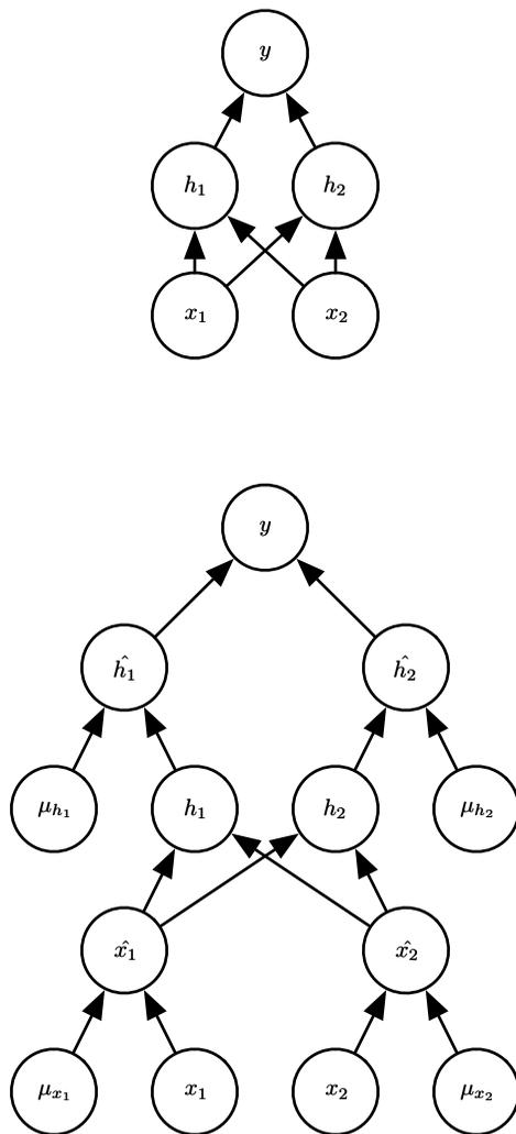
图 7.7: 在使用Dropout的前馈网络中前向传播的示例。(顶部) 在此示例中, 我们使用具有两个输入单元, 具有两个隐藏单元的隐藏层以及一个输出单元的前馈网络。(底部) 为了执行具有Dropout的前向传播, 我们随机地对向量  $\mu$  进行采样, 其中网络中的每个输入或隐藏单元对应一项。  $\mu$  中的每项都是二值的且独立于其他项采样。超参数的采样概率为 1, 隐藏层的采样概率通常为 0.5, 输入的采样概率通常为 0.8。网络中的每个单元乘以相应的掩码, 然后正常地继续沿着网络的其余部分前向传播。这相当于从图 7.6 中随机选择一个子网络并沿着前向传播。
