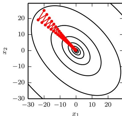
图 4.6: 梯度下降无法利用包含在 Hessian 矩阵中的曲率信息。这里我们使用梯度下降来最小化 Hessian 矩阵条件数为 5 的二次函数  $f(\mathbf{x})$ 。这意味着最大曲率方向具有比最小曲率方向多五倍的曲率。在这种情况下，最大曲率在  $[1, 1]^T$  方向上，最小曲率在  $[1, -1]^T$  方向上。红线表示梯度下降的路径。这个非常细长的二次函数类似一个长峡谷。梯度下降把时间浪费于在峡谷壁反复下降，因为它们是最陡峭的特征。由于步长有点大，有超过函数底部的趋势，因此需要在下一次迭代时在对面的峡谷壁下降。与指向该方向的特征向量对应的 Hessian 的大的正特征值表示该方向上的导数快速增加，因此基于 Hessian 的优化算法可以预测，在此情况下最陡峭方向实际上不是有前途的搜索方向。
