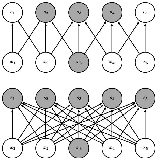
图 9.2: 稀疏连接, 对每幅图从下往上看。我们强调了一个输入单元  $x_3$  以及在  $s$  中受该单元影响的输出单元。(上) 当  $s$  是由核宽度为 3 的卷积产生时, 只有三个输出受到  $x$  的影响<sup>2</sup>。(下) 当  $s$  是由矩阵乘法产生时, 连接不再是稀疏的, 所以所有的输出都会受到  $x_3$  的影响。
