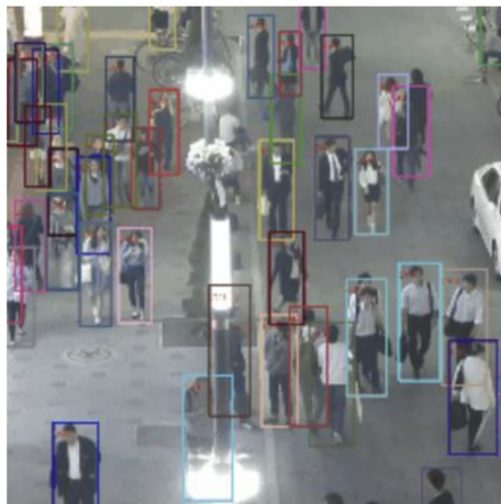
Object tracking: คล้ายกับ object detection แต่ว่า สร้าง unique ID สำหรับการตรวจจับวัตถุตอนเริ่มต้นด้วย
