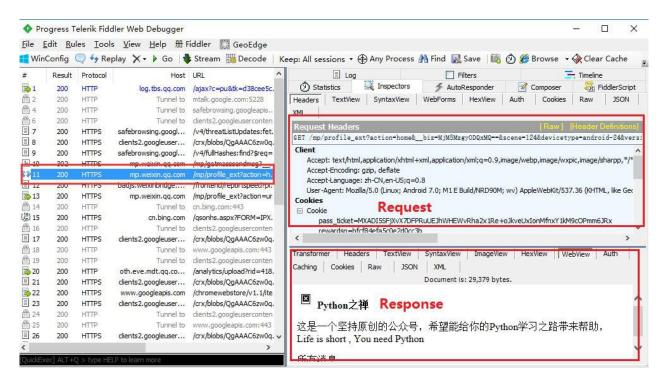
确定微信公众号的请求HOST是 mp.weixin.qq.com 之后,我们可以使用过滤器来过滤掉不相关的请求。
