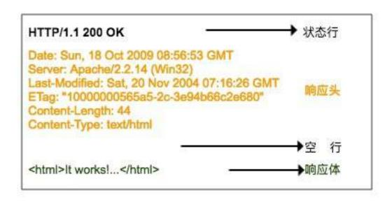
响应行也包含三部分,分别是服务端的 HTTP 版本号、响应状态码、状态说明,响应状态码常见有 200、400、404、500、502、304 等等,一般以 2 开头的表示服务器正常响应了客户端请求,4 开头表示客户端的请求有问题,5 开头表示服务器出错了,没法正确处理客户端请求。状态码说明就是对该状态码的一个简短描述。
