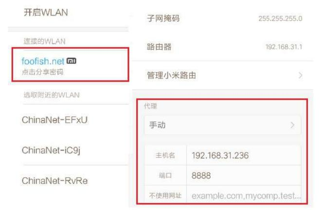
测试代理有没有设置成功可以在手机浏览器访问你配置的地
