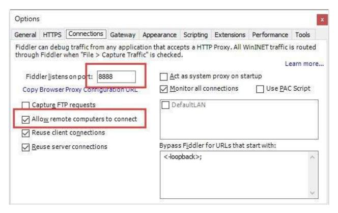
接下来你需要配置手机,我们以 Android 设备为例,现在假设你的手机和电脑已经在同一个局域网(只要连的是同一个路由器就在同局域网内),找到电脑的 IP 地址,在 Fiddler 右上角有个 Online 图标,鼠标移过去就能看到IP了,你也可以在CMD窗口使用 ipconfig 命令查看到
