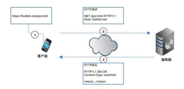
HTTP 协议的请求和响应都必须遵循固定的格式,只有遵循统一的 HTTP 请求格式,服务器才能正确解析不同客户端发的请求,同样地,服务器遵循统一的响应格式,客户端才得以正确解析不同网站发过来的响应ni。
