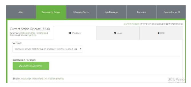
Windows 默认安装在 C:\Program Files\MongoDB\Server\3.6\, macOS 也可以直接通过 brew 命令安装, Linux平台直接下载压缩包解压即可。
