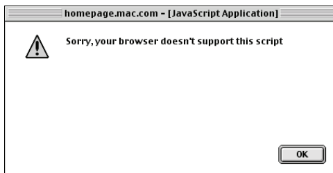
图 3-3 对象探测拒绝这种老式浏览器（Mac 的 Netscape 4）并显示这个错误消息
