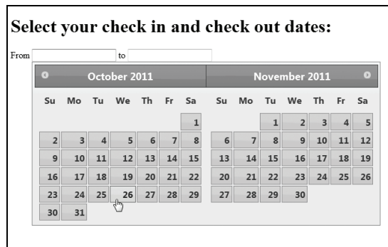
图 16-8 在月份名称栏的左右两侧有箭头形状的按钮，你可以单击它们来更改月份的显示。要选择开始日期，只要单击左侧日历中的日期即可
