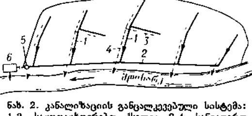
ნახ. 2. კანალიზაციის განცალკევებული სისტემა: 1,2—საყოფაცხოვრებო ქსელი; 3,4—სანიაღვრო ქსელი; 5—სატუმბავი სადგური; 6—საწმენდი ნაგებობა.
