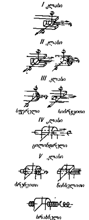
კინემატიკური წყვილი. I — II კლასები — უმაღლესი; III — V კლასები — უმაღლესი.
