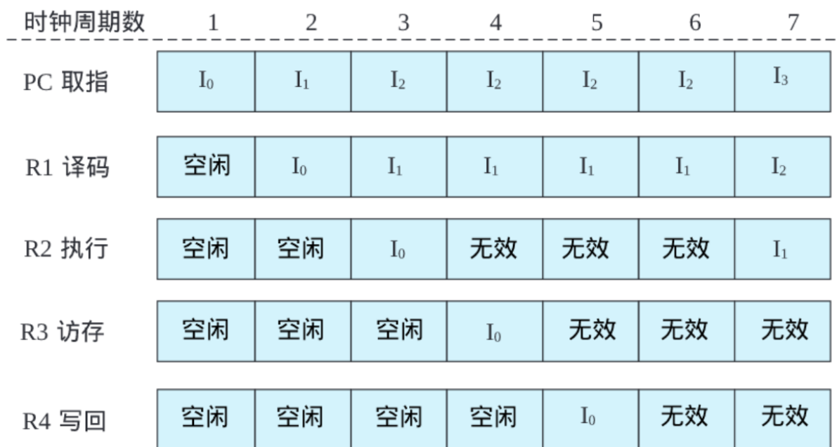
图 9.11: 有阻塞的处理器部件时空图
