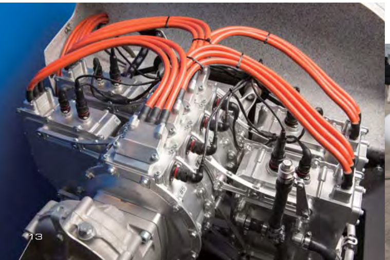
JAXA独自技術の多重化モーター。直列に4つのモーターを繋ぎ安全性を確保している。
