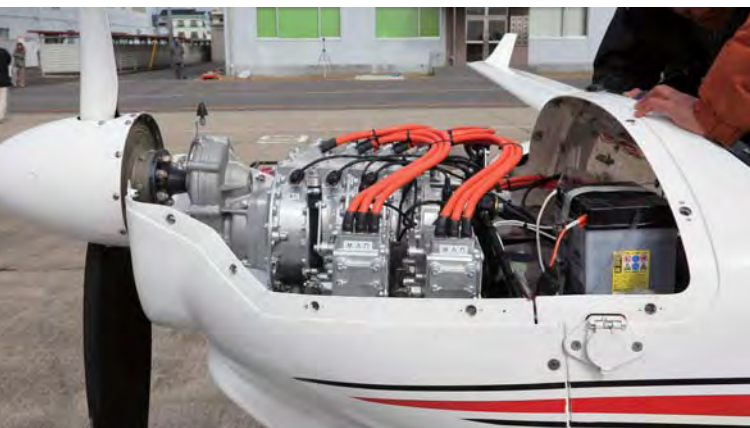
JAXA独自技術の多重化モーター。直列に4つのモーターを繋ぎ安全性を確保している。
