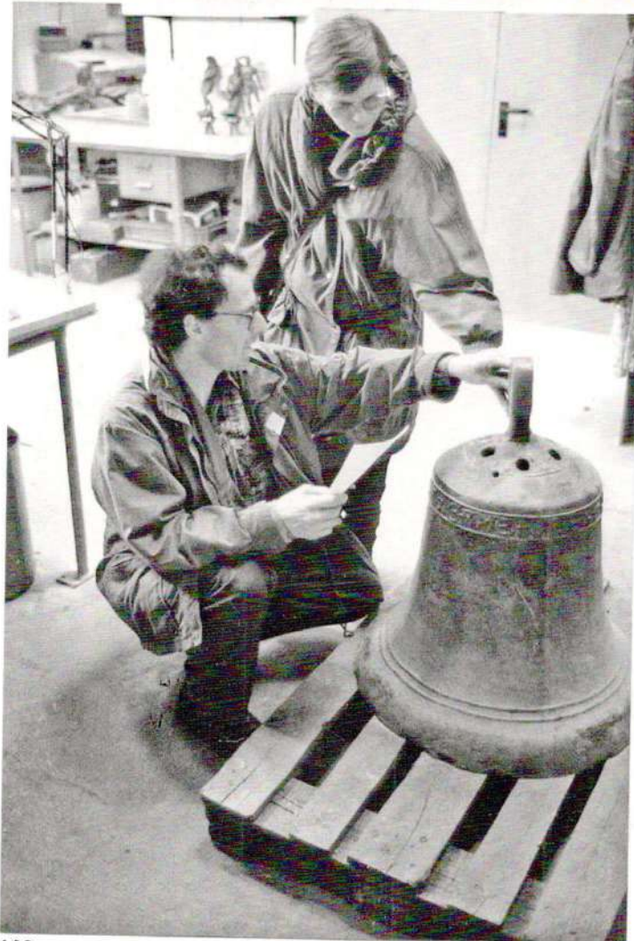
Abb. 19: Reparatur der Glocke aus dem Kreuzgang: Anpassen des Wachsmodells der neuen Krone (Photo: H. Derp).
