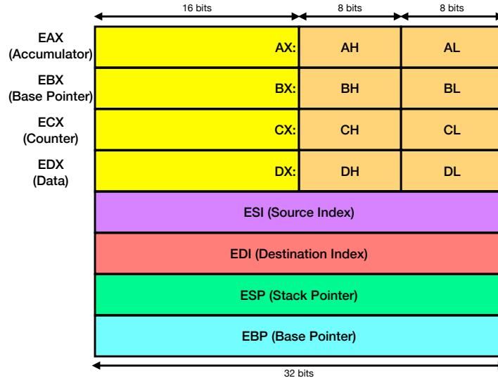
Arhitectura procesorului este pe 32 de biti, astfel ca registrii utilizati sunt tot pe 32 de biti. Un registru reprezinta o cantitate mica de spatiu de stocare pe unitatea centrala de procesare, al carui continut poate fi accesat mai rapid decat datele stocate in alt loc (de exemplu, in memorie sau chiar mai lent pe hard-disk).
