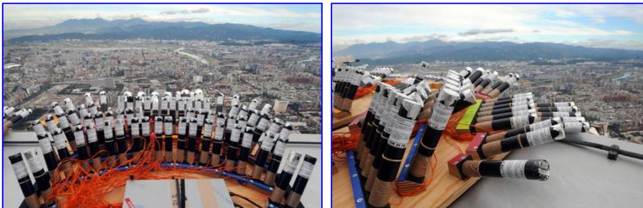
圖 8：煙火彈發射筒的架設方式是以一個或一組為單位
