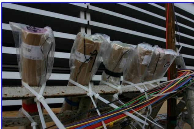
圖 7：煙火彈發射筒固定於鷹架上，必須注意發射方位和順序
