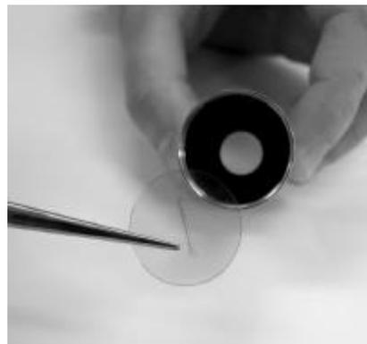
圖七 將測微刻度尺放進接目鏡內
