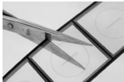
圖四 剪取一片測微刻度尺
