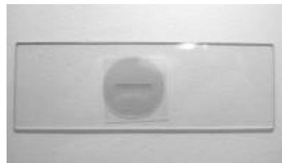
圖五 載物台測微尺
