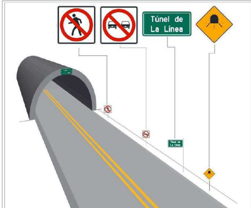
Figura 4.20 Ejemplo de señalización vertical y horizontal en la zona previa de acceso a un túnel bidireccional
