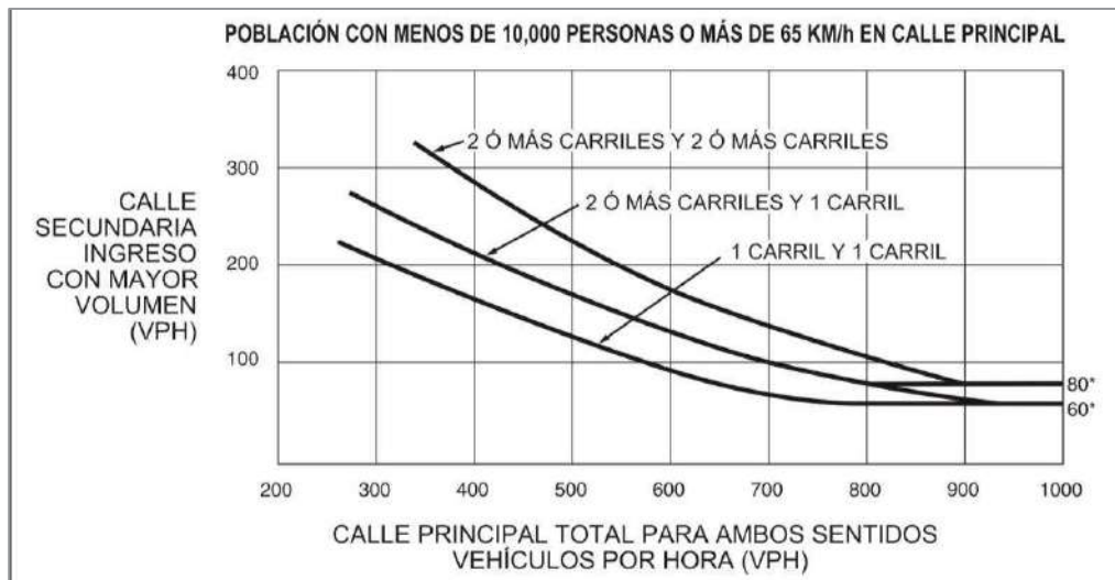
Figura 6.17: Se utiliza en función a la velocidad de la vía principal y población en zona urbana
