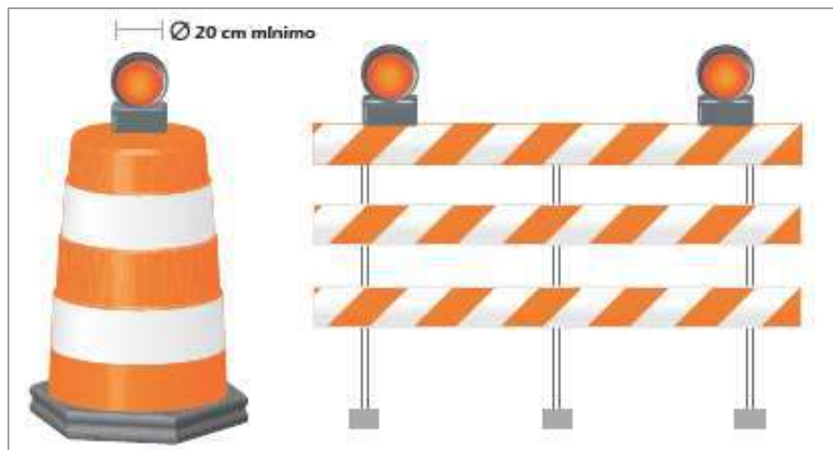
Figura 5.9 Ejemplo de barreras reforzadas con dispositivos luminosos.
