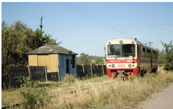
Zarządzający kolejami dojazdowymi PKP jeszcze w czasach „realnego socjalizmu” wykazali się zdolnością przewidywania i zakupili autobusy szynowe (wraz z doczepami biernymi), które miały zastąpić nieefektywne ekonomicznie składy wagonowe prowadzone lokomotywami dużej mocy (450 KM) serii Lxd2. Widoczny na zdjęciu wagon motorowy serii MBxd2 jest jednym z 20 wagonów na tor 750 mm, wyprodukowanych w 1986 r. w rumuńskich zakładach 23. August/Faur. Ten egzemplarz (MBxd2-226 spotkany na przystanku w Robacznynie) do dzisiaj pracuje na Kolei Śmigiełskiej. Pomysł był znakomity, ale spóźniony; do tego rumuński projekt i wykonanie okazały się (jak już bywało przedtem) tradycyjnie bardzo podrzędnej jakości. Na przykład do napędu wykorzystano typowy silnik autobusowy węgierskiej firmy Ikarus, który (ze względu na niewłaściwe chłodzenie) przegrzewał się i szynobus nie był w stanie poprowadzić zakładanych dwóch wagonów doczepnych
