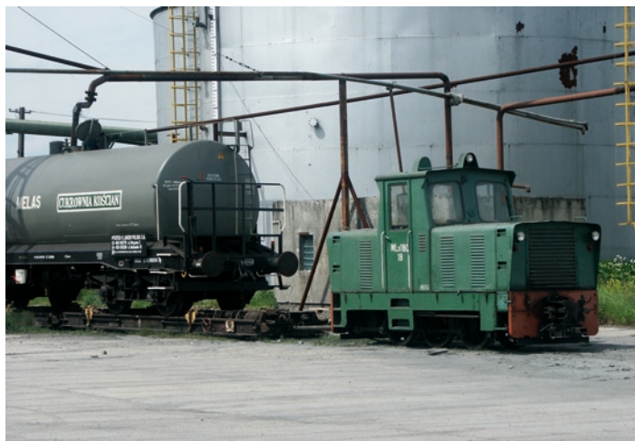
Zakładowa lokomotywa Wls180-18 (wariant o mocy 180 KM) podstawiła cysternę normalnotorową na transporterach pod melaśniki w Cukrowni Zbiorsk. Warto zwrócić uwagę właśnie na transporterzy do wagonów normalnotorowych, powszechnie używane od początku lat 70. XX w. Wyeliminowały one pracę przeładunkową na punktach stycznych i po zaniku ruchu pasażerskiego przyczyniły się do utrzymania w eksploatacji większości kolei wąskotorowych w Polsce
