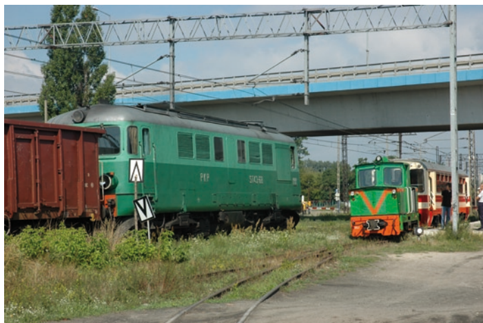
Goliat i Dawid, czyli dwa oldtimery w planowej służbie – normalnotorowa lokomotywa ST43-68 jest jedną z 422 maszyn kupowanych od 1965 r. w Rumunii (produkowane na licencji szwajcarskiej były pierwszymi maszynami dużej mocy, używanymi przez PKP) i wąskotorowa Lxd1-252 (produkowana w latach 1960–1969; z serii 181 lokomotyw w dwóch wykonaniach, o mocy 150 lub 180 KM, na PKP trafiły 33 lokomotywy), która zapoczątkowała erę liniowych lokomotyw spalinowych średniej mocy na kolejach dojazdowych i w przemyśle. Spotkanie sfotografowane na stacji Starachowice Wsch. w sierpniu 2008 r.
