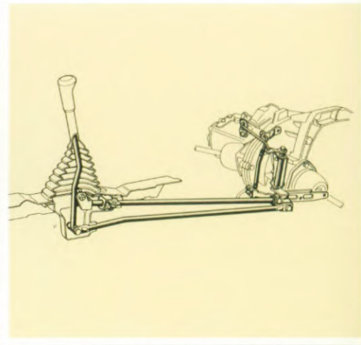
Nieuw schakelmechanisme: voor sneller en direkter schakelen.
