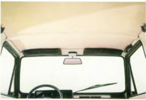
Nieuwe, optimaal isolerende, uit één stuk gevormde hemelbekleding.
