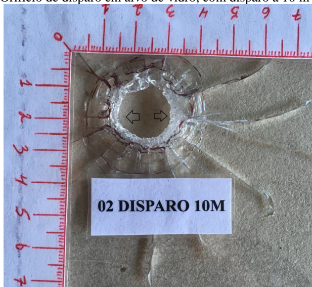
Figura 6. Orifício de disparo em alvo de vidro, com disparo a 10 m calibre .40.
