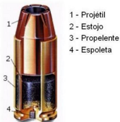
Figura 4. Nomenclatura de uma munição
