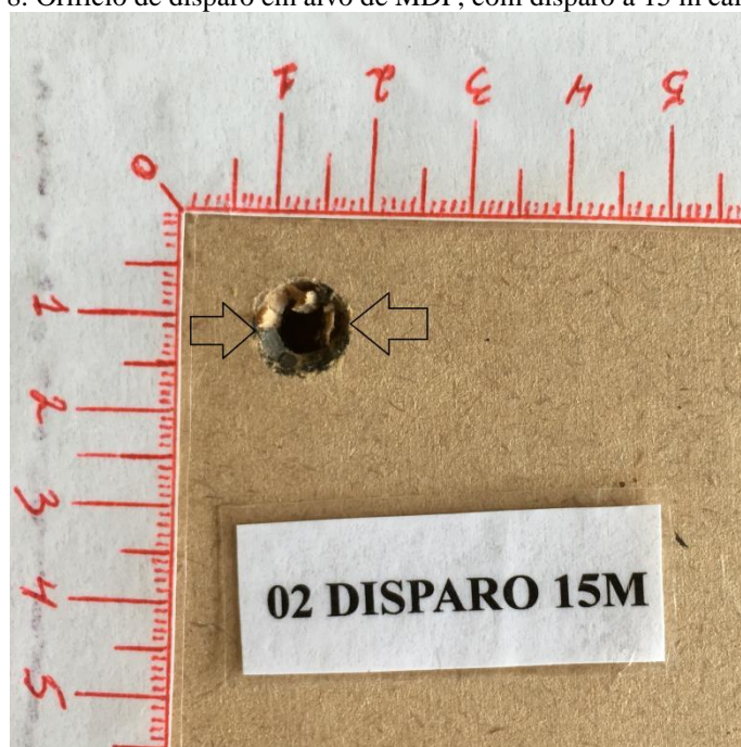
Figura 8. Orifício de disparo em alvo de MDF, com disparo a 15 m calibre .40.
