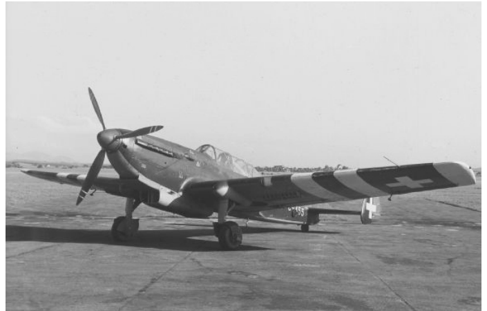
C-3603 w jednostce liniowej. Dobrze widoczne skrócone skrzydła i wyrzutniki bombowe
