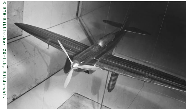
Model tunelowy C-36 jeszcze z pojedynczym usterzeniem pionowym
