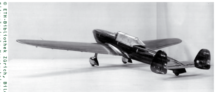
Model tunelowy C-3601 z podwójnym usterzeniem pionowym
