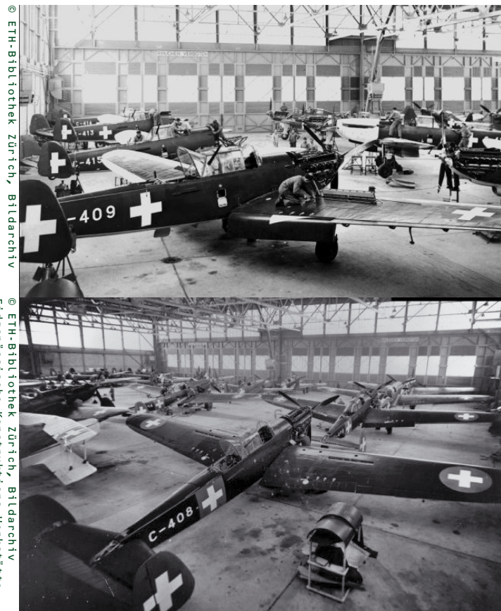
Montaż końcowy C-3603 w hali zakładów Pilatus AG. Zwracają uwagę eliptyczne końcówki skrzydeł pierwszych egzemplarzy.
