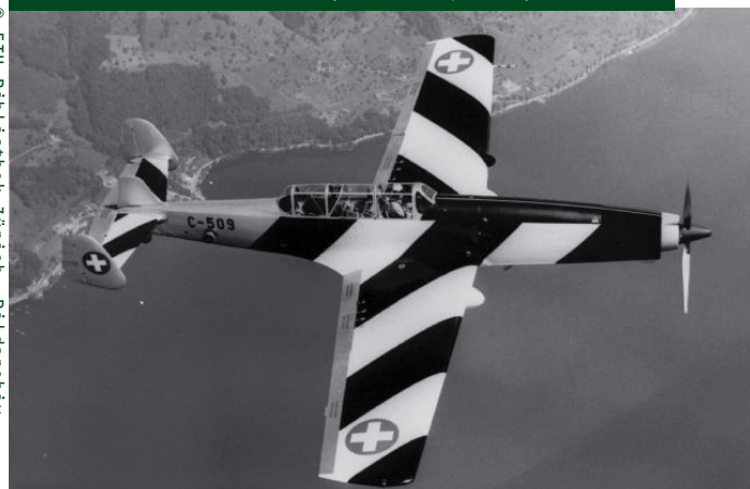
C-3605 w pełnej krasie. Doskonale widoczna wydłużona część nosowa i dodatkowy statecznik pionowy.
