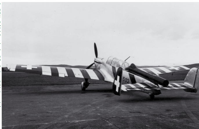
C-3603 Schlepp z rurą osłaniającą linkę holowniczą. Samolot w barwie srebrnej z czerwonymi pasami ostrzegawczymi. Widoczny na zdjęciu egzemplarz C-502 posłużył później jako prototyp wersji C-3605.
