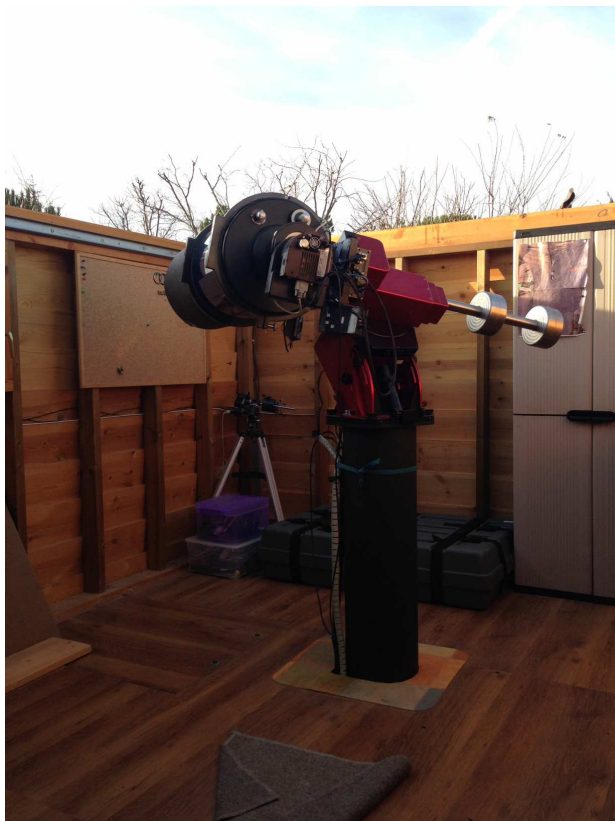
Figura 3. Observatorio privado de David Cejudo (SC de 30 cm con cámara CCD SBIG STX-8ME).
