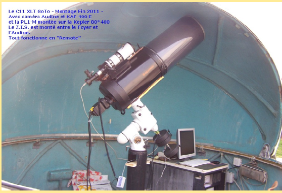
Figura 2. El telescopio usado en la campaña según montaje a finales de 2011: C11 XLT GoTo con la Cámara Audine 400E. El controlador de focal Z.I.S (ver texto) está montado entre el foco y la Audine. La escala de placa para este tren óptico resultó ser de 0,485 \pm 0,005 "/pixel. También se muestra el telescopio secundario (Kepler 80/400) y la cámara PL1-M. Todo el conjunto opera en modo remoto.
