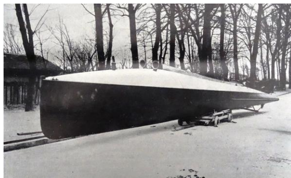
Le Dubonnet, grand Racer de 15 mètres à deux moteurs Lorraine-Dietrich de 120 ch vu à Monaco en 1906. (LFA).
