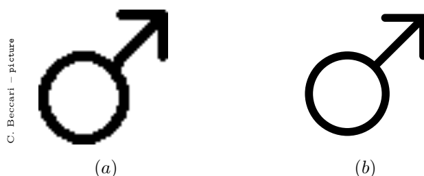
Figura 18.5: Il simbolo di maschio fortemente ingrandito: (a) font a matrice di punti; (b) font vettoriale.
