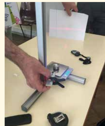
Figur 4: Polymertråd med vikt och våg. Trådens diameter bestämdes med laserpenna.
