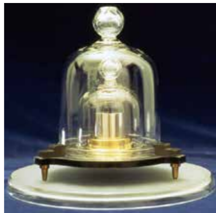
Figur 1. Bilden visar inte den internationella kilogramprototypen, men väl det svenska rikskilogrammet. Idag är Sveriges kilo placerad i säkert förvar i Borås och hanteras av det nationella metrologiinstitutet inom RISE. Det används idag ytterst sparsamt för att minimera slitage och föroreningar.
